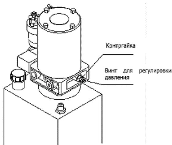
часовой стрелке, давление в системе увеличивается. Пока винт вращается против часовой стрелки, давление в системе уменьшается.
